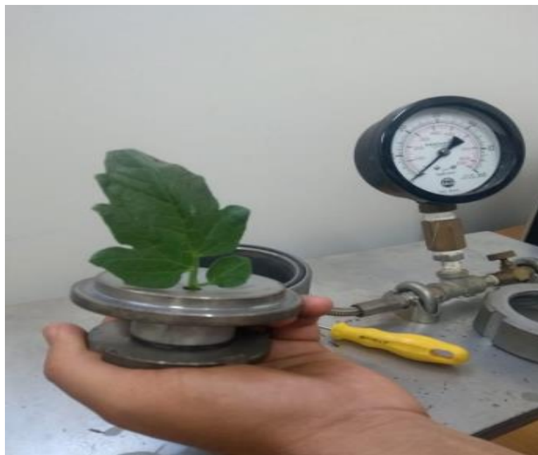
Figura 5. Leitura do potencial hídrico foliar – \Psi_w por meio da bomba de pressão do tipo Scholander® (modelo 3005-1412, Soil moisture Equipment Corp. , EUA) para a cultura do tomate em Laboratório de Hidráulica e Irrigação do Instituto Federal de Educação, Ciência e Tecnologia Goiano, Rio Verde, Goiás, 2019.
