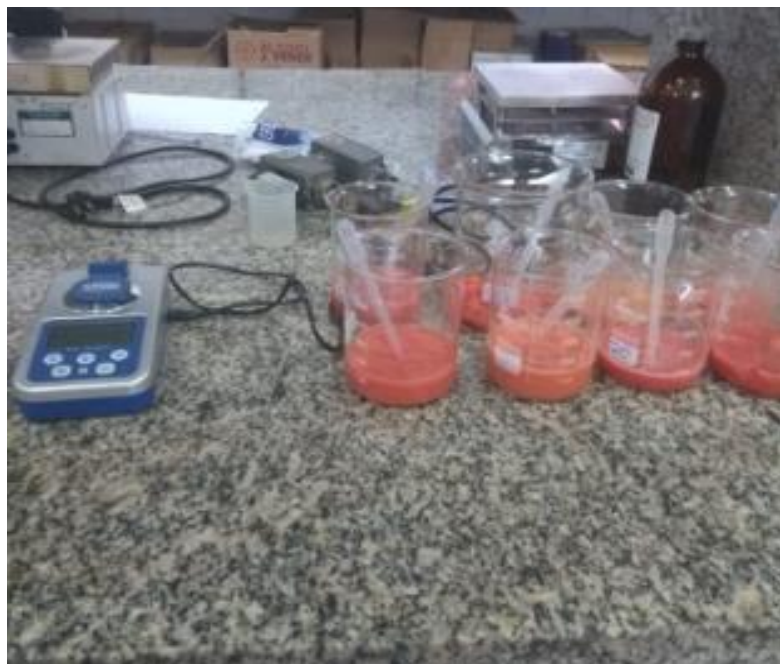
Figura 7. Refratômetro A.KRÜSS Optronic® utilizado para a obtenção do °Bx do tomateiro cultivado em estufa agrícola do Instituto Federal de Educação, Ciência e Tecnologia Goiano, Rio Verde, Goiás, 2019.
