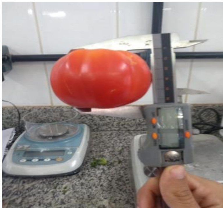
Figura 5. Obtenção do diâmetro longitudinal de frutos – DLF e diâmetro transversal – DTF por meio do paquímetro digital Starrett® série EC799 na cultura do tomateiro cultivado em estufa agrícola do Instituto Federal de Educação, Ciência e Tecnologia Goiano, Rio Verde, Goiás, 2019.
