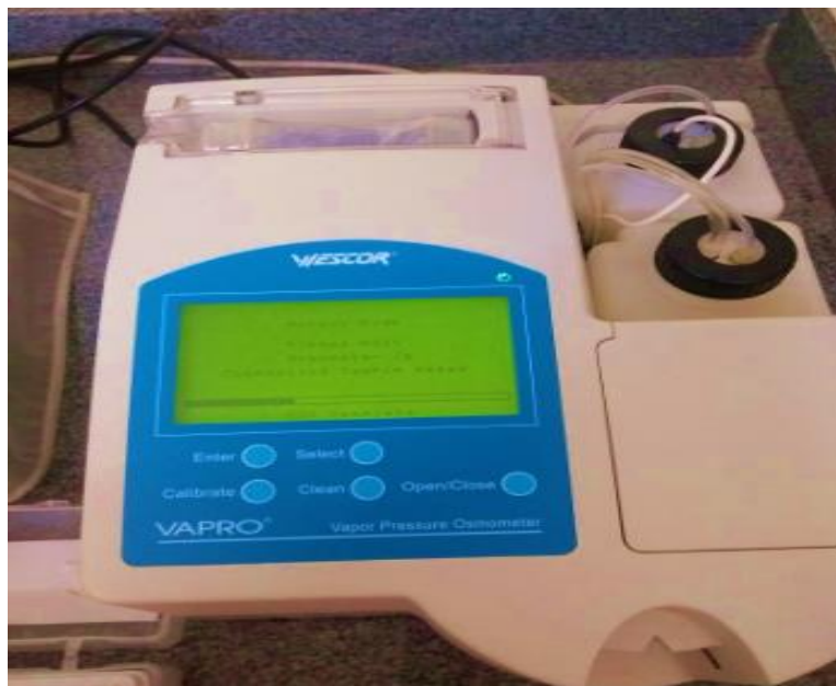
Figura 6. Osmômetro (modelo VAPRO 5600, Elitech ® , França) utilizado para obtenção do potencial osmótico da folha – \Psi_s da cultura do tomate em Laboratório de Ecofisiologia e Produtividade Vegetal do Instituto Federal de Educação, Ciência e Tecnologia Goiano, Rio Verde, Goiás, 2019.
