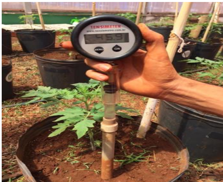
Figura 4. Leitura da tensão realizada por meio do tensímetro da marca Hidrosense® e modelo HID32 no experimento com a cultura do tomate em estufa agrícola do Instituto Federal de Educação, Ciência e Tecnologia Goiano em Rio Verde, Goiás, 2019.
