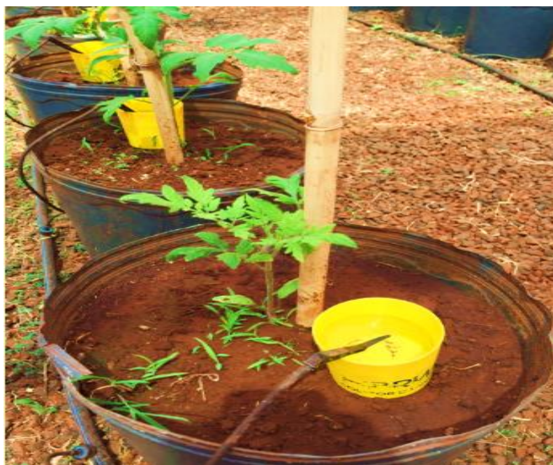
Figura 3. Coletores utilizados para cálculos de uniformidade de distribuição de água em experimento com a cultura do tomate em estufa agrícola do Instituto Federal de Educação, Ciência e Tecnologia Goiano em Rio Verde, Goiás, 2019.
