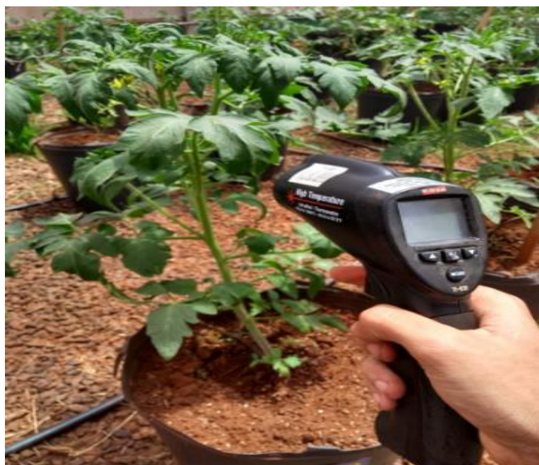
Figura 9. Termômetro infravermelho (modelo 4000.4GL, Everest Interscience ® , Tucson, AZ, USA) utilizado na obtenção da temperatura foliar – TF do tomateiro cultivado em estufa agrícola do Instituto Federal de Educação, Ciência e Tecnologia Goiano, Rio Verde, Goiás, 2019.
