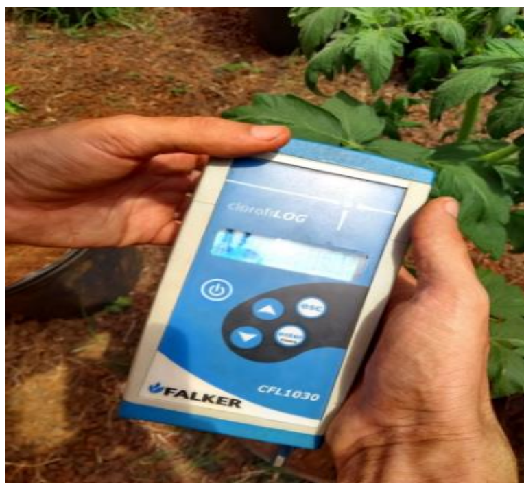
Figura 8. Clorofilômetro da marca comercial ClorofiLOG ® modelo CFL 1030 utilizado na obtenção das clorofilas 'a', 'b' e total ( a + b ) do tomateiro cultivado em estufa agrícola do Instituto Federal de Educação, Ciência e Tecnologia Goiano, Rio Verde, Goiás, 2019.
