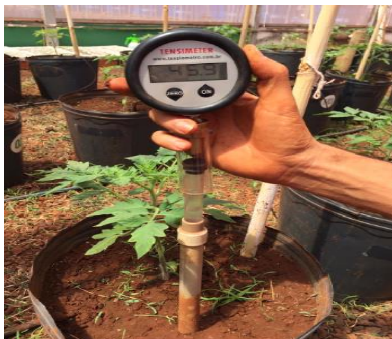
Figura 4. Leitura da tensão realizada por meio do tensímetro da marca Hidrosense® e modelo HID32 no experimento com a cultura do tomate em estufa agrícola do Instituto Federal de Educação, Ciência e Tecnologia Goiano em Rio Verde, Goiás, 2019.
